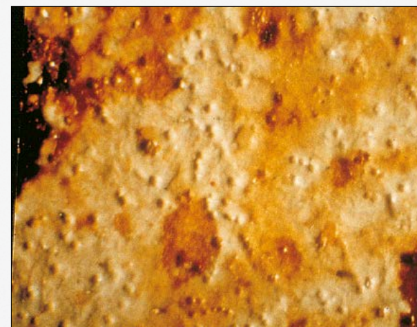
Lackfilmrückseite mit starken Unterrostungen, 20fache Vergrößerung
