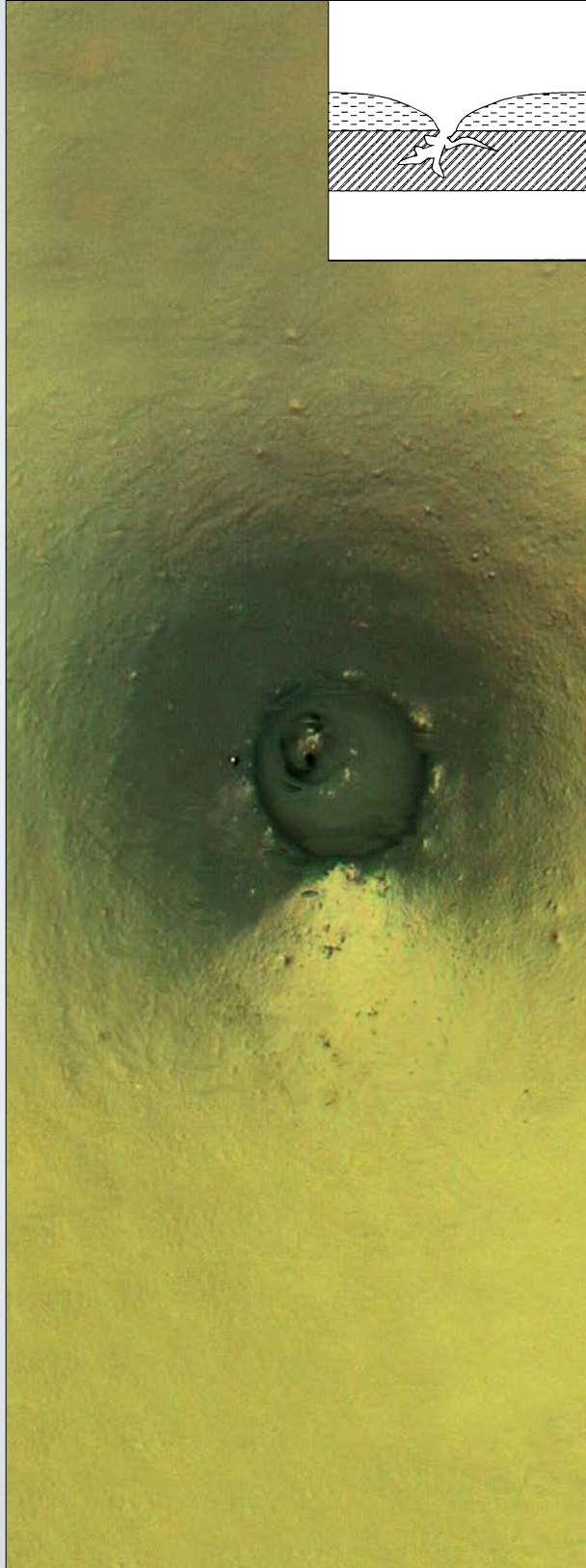
Nadelstich durch Pore im Kunststoff, 20fache Vergrößerung
