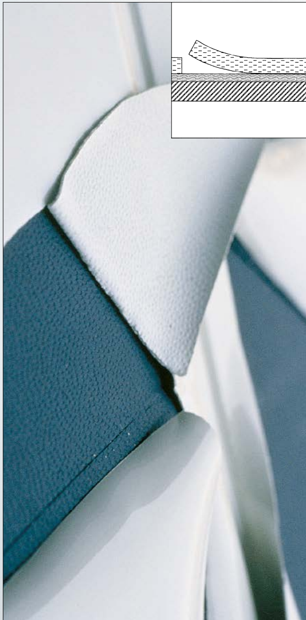
Haftungsstörungen durch ungenügende Reinigung der Kunststoffoberfläche, 2fache Vergrößerung
