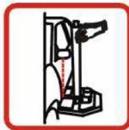
**Achtung! Das Anheben in der Mitte oder im hinteren Bereich ist nicht gestattet. Vor dem Hochfahren des Minilifts ist sicherzustellen, dass die Gummiauflage des Schwellerhalters sich am Aufnahmeplatz für Wagenheber befindet. (Aufnahmepunkt abhängig vom Fahrzeugtyp!)**
