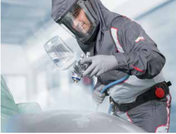
Adapter überflüssig – SATA RPS Einwegbecher passen direkt auf die SATAjet 5000 B – das reduziert Gewicht und Reinigungsaufwand
